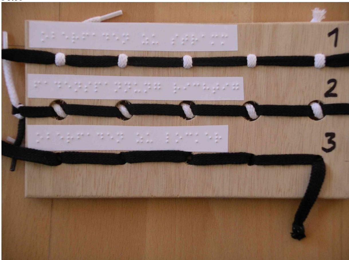
1. Oberfaden zu stramm (Unterfaden bildet an der Oberseite vom Stoff Schlaufen)
