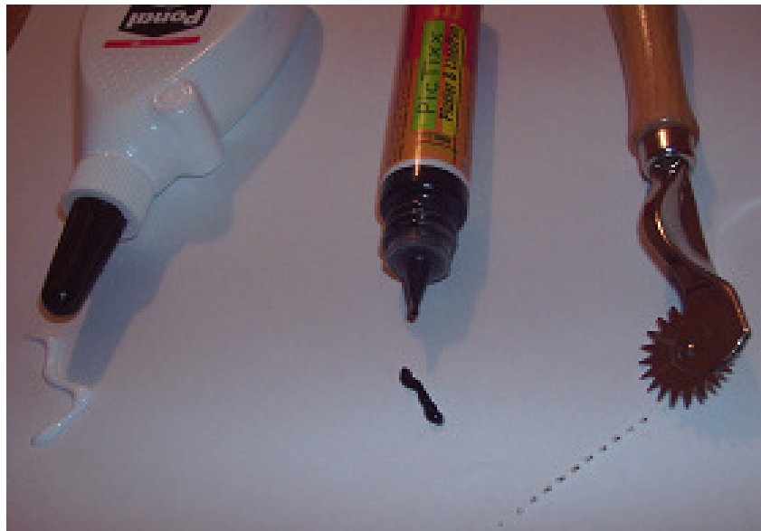
Abb.2: Hilfsmittel zum tastbar machen von Linien von links: Holzleim (erhabene transparente Linie) Plusterpen (erhabene farbige Linie) Kopierradchen (Linie perforiert)
