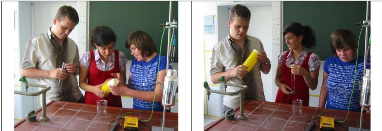
V2) Wir füllen das Thermosgefäß mit 200 ml Wasser und tauchen die Drahtspule ein. Nun messen wir die Erwärmung des Wassers in Abhängigkeit von der Zeitdauer.
