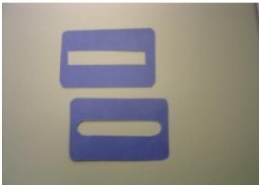
Eine weitere Möglichkeit ist eine Schablone aus dicker Laminierfolie mit eingelegtem buntem Papier, diese ist jedoch labil und nutzt sich schneller ab. Für gelegentliche Unterschriften jedoch ausreichend. Ausgeschnitten wird sie mit einem scharfen Messer oder Skalpell.
